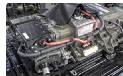
Montáž jednotky řízení energie elektromotoru na úrovni přední nápravy Toyota Mirai.
