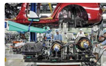
Montáž vysokotlakých vodíkových nádrží a palivových článků společně s měničem napětí.
