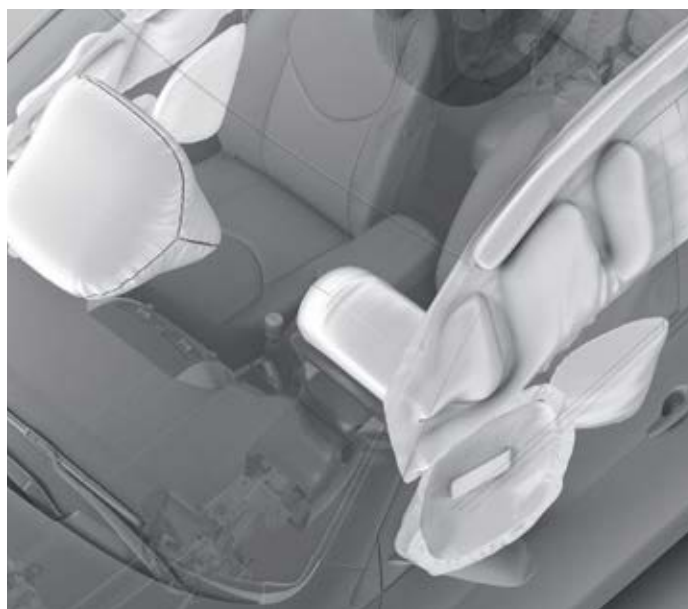
Airbagy pro řidiče a spolujezdce, boční okenní airbagy chránící hlavu a hrudník v 1. řadě sedadel, boční okenní airbagy ve 2. a 3. řadě
