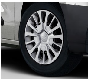
16" ocelové disky s kryty a pneumatikami 205/60 R16 96H XL
