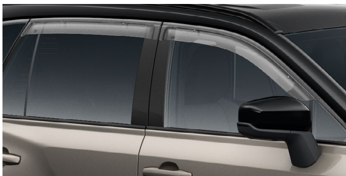
Přední a zadní okenní deflektory, sada 4 ks, instalace 0,8 h
